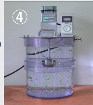
容器の壁面に当たった 液流が上と下に分かれて 立体的な流れになります。
