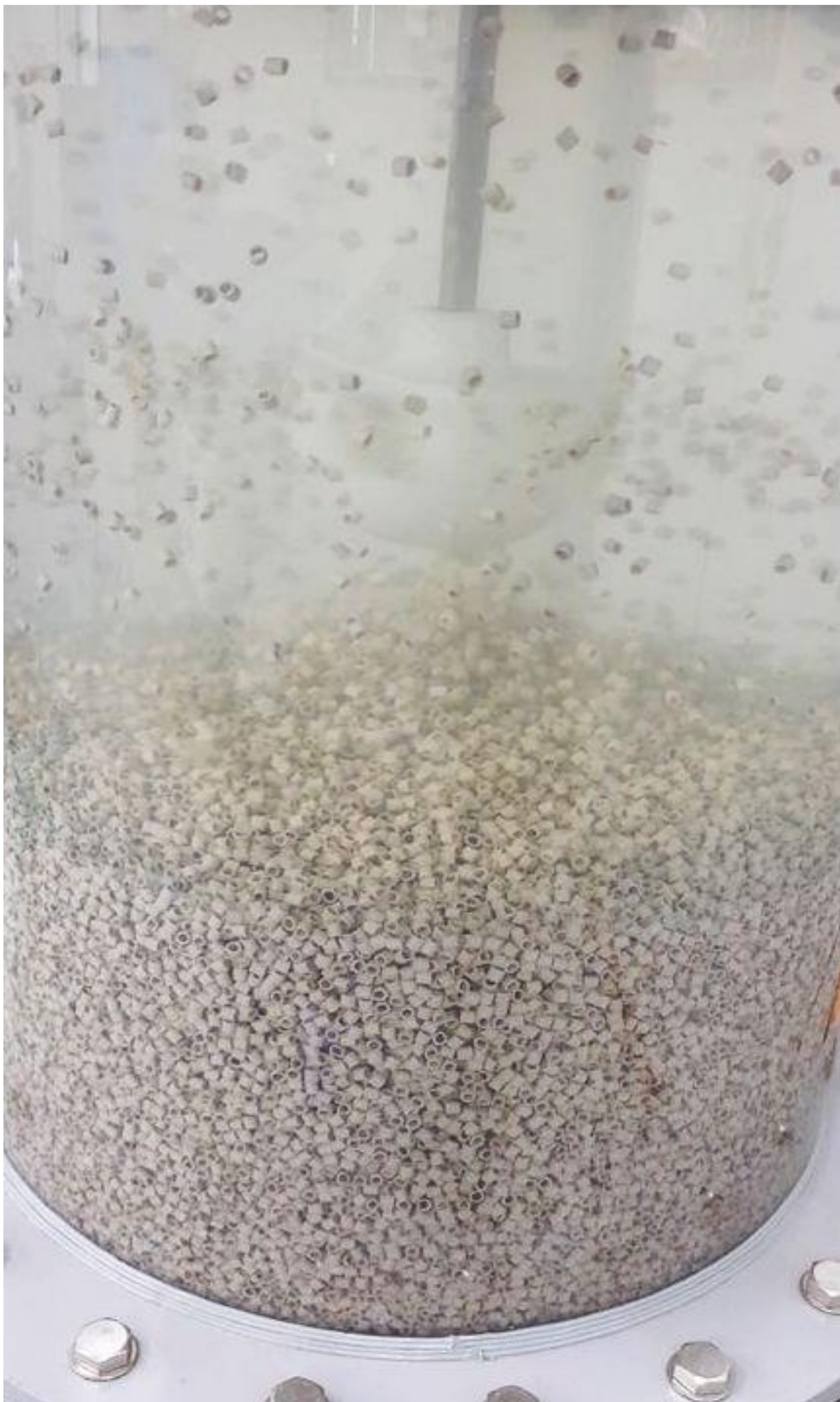
C-Mixによる担体を利用したバクテリア処理槽の攪拌
